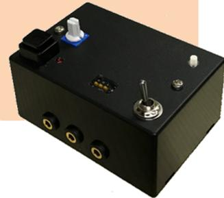
パルススイッチャーとは、外部スイッチでBDアダプタや3V機器（リレーなど）を一定時間動かす装置です。ロータリースイッチやディップスイッチの組みあわせて、様々な動作を選択することができます。動作内容により入力禁止時間も設定されます。（詳細はP.3）
